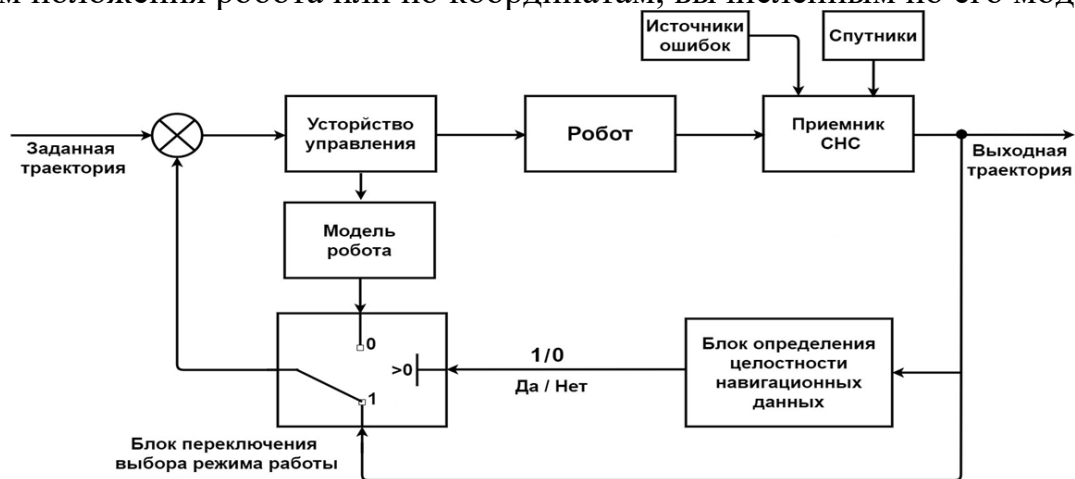
Рисунок 9 - Структурная схема системы управления мобильным роботом с выбором режима управления
