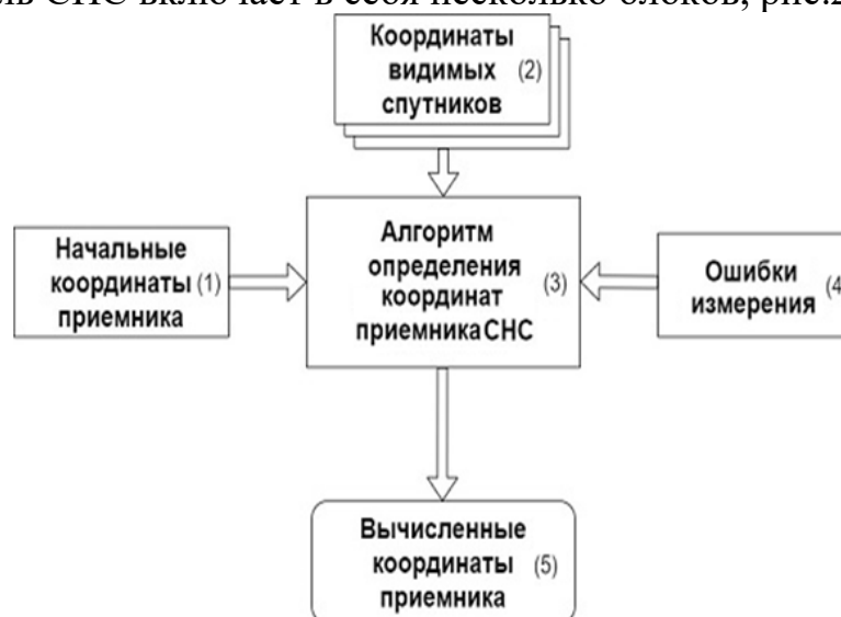
Рисунок 2 - Схема моделирования СНС
