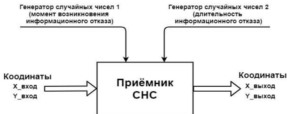
Рисунок 4 - Схема моделирования информационного отказа приемника СНС
