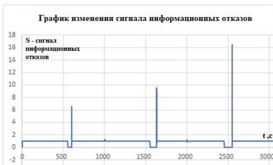
Рисунок 8 - Результаты определения интервалов информационных отказов приемника СНС
