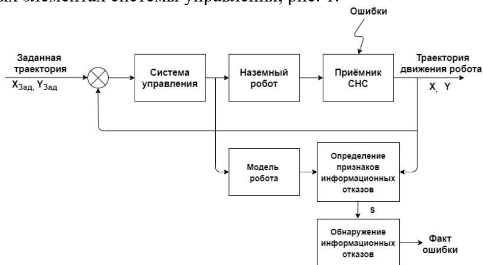
Рисунок 1 - Структурная схема системы управления мобильным роботом с автономным контролем приемника СНС
